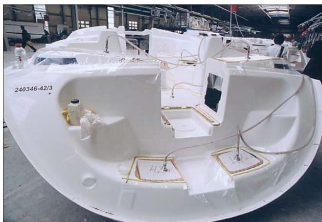
Тиковые настилы приклеиваются с использованием "вакуумного мешка"
