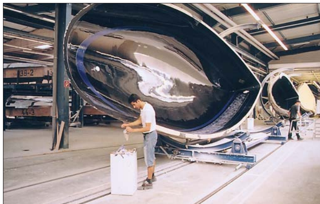
В подготовленную матрицу уже напылена цветная полоса ватерлинии
