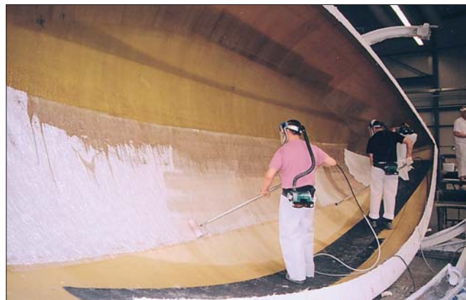
Рабочий орудует валиком, прямо в который по шлангу подается смола
